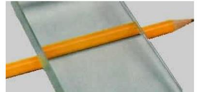
*Das Licht, welches vom Bleistift gestreut wird, tritt in die Glasplatte ein. Dabei wird es zum Lot hin gebrochen. Beim Austritt des Lichtes auf der anderen Seite der Glasplatte wird das Licht vom Lot weg gebrochen. Durch diese zweimalige Brechung ist das Licht, welches durch die Glasplatte dringt, gegenüber dem ungebrochenen Lichtstrahl parallel verschoben.*
