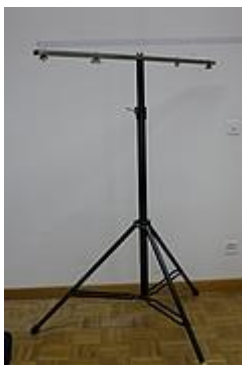
Traverse Auf jedem Stativ lässt sich eine Traverse anbringen. So können zwei oder gar vier Scheinwerfer montiert werden.
